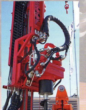
Hydraulik pur: Blick auf den hydraulischen Bohrantrieb.
