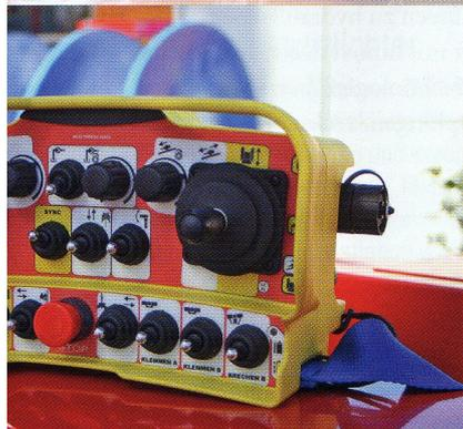
Die hydraulischen Fahr- und Bohrfunktionen sind durch Funkfernbedienung steuerbar.
