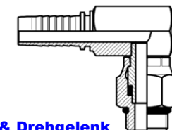
SAE & Drehgelenk Nur für gelegentliche langsame Schwenkbewegungen
