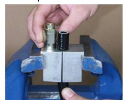
**MAL-03: Montageanleitung für Thermoplastik-Schraubarmaturen Baureihe T**
