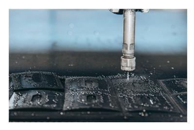
Das Schneiden per Hochdruckwasserstrahl ist höchst effizient, effektiv und industriell etabliert. Mit dem Verfahren des Wasserstrahlschneidens trennen unsere Partner Werkstoffe mit präziser Genauigkeit. Großflächige Konturen oder filigrane Dichtungen mit engsten Radien werden auf mehreren Anlagen geschnitten. Geschnitten wird je nach Material mit Reinwasser oder mittels Quarzsandzusatz.
