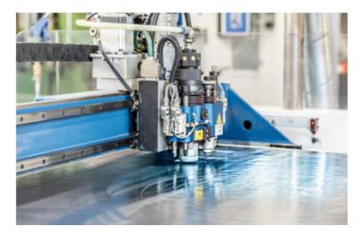
Auf modernen CNC Plottern wird das Ausgangsmaterial mit höchster Präzision zugeschnitten. Egal ob lange Schnitte, enge Radien oder spezielle Konturen. Die vom Computer verarbeiteten Arbeitsaufträge werden digital archiviert und sind jederzeit zum Zeitvorteil unserer Kunden vollumfänglich abrufbar. Dies erleichtert Folgeproduktionen und reduziert die Kosten.
