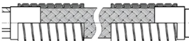
**FG2 Flexo-Protect® Feuerschutzschlauch rot mit Silikonbeschichtung**
