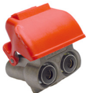
Luftkupplungen Serie LK2 Kuppl f. Sattelzugmaschine Nr. BLK-07 - Seite 08-04
