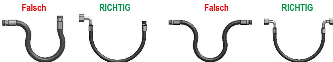
**D** Schlauchleitungen nur torsionsfrei einbauen, sie dürfen nicht verdreht werden.
