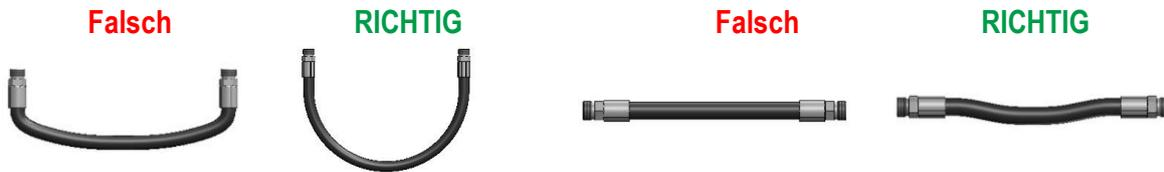
**C** Schlauchleitungen dürfen nicht überbogen werden, daher sollten Rohrbogen als Umlenkung eingebaut werden.
