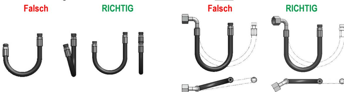
**E** Schlauchleitungen dürfen nicht abknicken, bei Bedarf kann ein Schlauchsattel verwendet werden.
