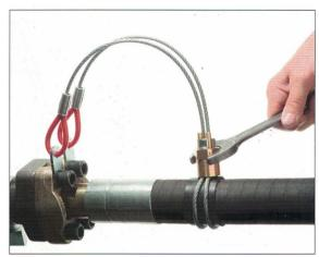
Vibrationsschädigungen die Schlauchfangsicherung betreffend nehmen ab, je weiter man in Richtung Schlaucharmatur schaut. Dies wurde konstruktiv berücksichtigt.
