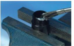
Für das entsprechende Rohr den dazugehörigen Vormontagegestutzen in den Schraubstock spannen.
