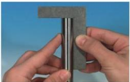
Wir empfehlen nur nahtlose weich geglähte Edelstahlrohre aus Werkstoff 1.4571 nach EN ISO 10216-5 oder DIN EN ISO 1127 Toleranzklasse D4/T3.
