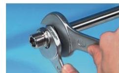
Nach Gutbefund das vormontierte Rohr in den Verschraubungsstutzen einsetzen.
