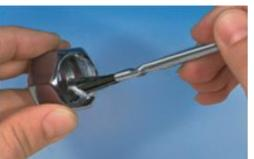
Den 24°-Innenkonus und das Außengewinde des VOMO, sowie die gesamte Innenseite der Überwurfmutter mit Spezial-Montagepaste DTS-07-301 einfetten.
