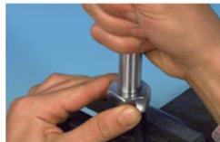
Die Einheit Rohr, Schneidring und Überwurfmutter in den VOMO schieben. Die Überwurfmutter bis zur fühlbaren Anlage der Hand auf den VOMO aufschrauben. Dabei das Rohr gegen den Anschlag im Grund des VOMOS drücken.
